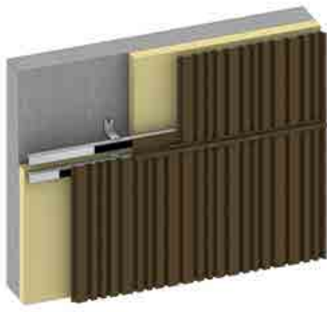
SEZIONE VERTICALE | MARCAPIANO VERTICAL CROSS-SECTION | BELT COURSE
