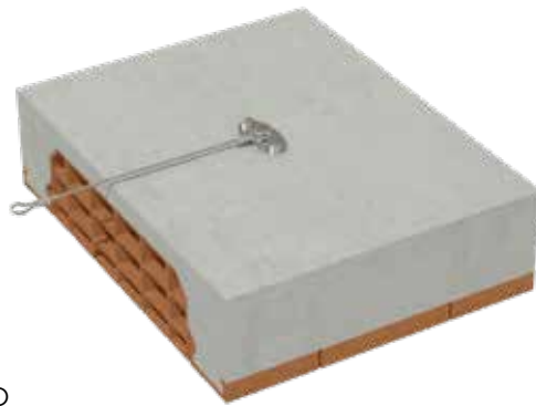
SOLAIO IN LATEROCEMENTO
